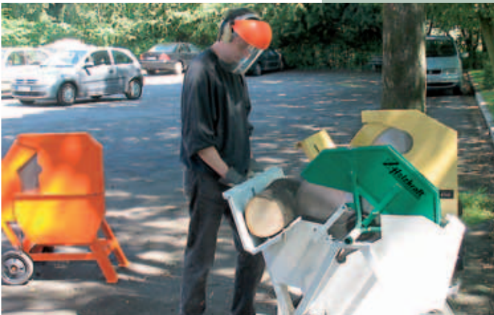
Eine vorbildliche Lösung ist hier die Mechanik der Sicherheitspendelhaube. Beim Sägen wird immer nur so viel vom Sägeblatt freigegeben, wie zum Schnitt benötigt wird.
